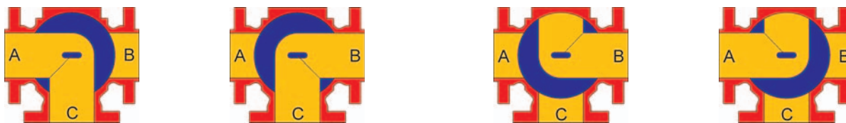
Bild 5 · Schaltfunktionen des 3-Wege Kugelhahns BR 26l mit horizontaler L-Bohrung
