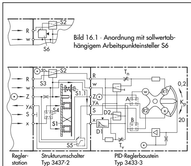
Bild 16.1 · Anordnung mit sollwertabhängigem Arbeitspunkteinsteller S6
