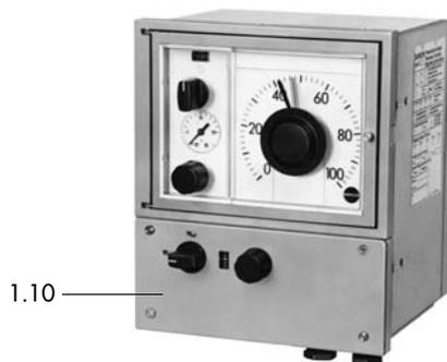
Bild 6 · Festwert- und Folgeregler mit Zusatzeinheit (1.10) zur Umschaltung von interner auf externe Führungsgröße, Ausführung mit Reglerstation Typ 3432-06
