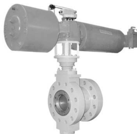
Rys. 1 · Kłapa dla wysokich ciśnień, typ LTR 43, w wykonaniu z podwójnym kołnierzem, średnica nominalna 10", ANSI Class 1500, z siłownikiem pneumatycznym i ustawnikiem pozycyjnym
