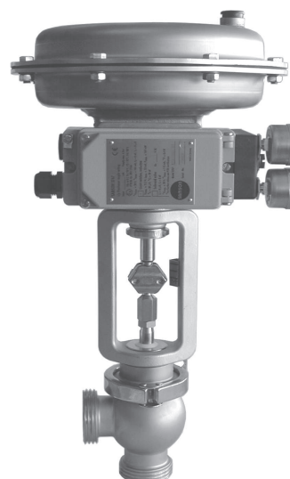
Rys. 2 · Zawór regulacyjny typu 3347-7, wykonanie kute z końcówkami gwintowanymi, zgodnie z przepisami 3A i EHEDG
