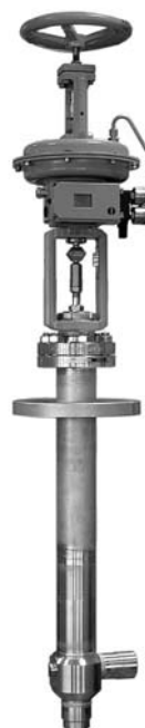
Rys. 2 Typ 3248-7 · Kątowy zawór ze stali szlachetnej, z siłownikiem pneumatycznym, z ustawnikiem pozycyjnym, regulatorem ciśnienia, manometrami i pokrętkiem do nastawy ręcznej
