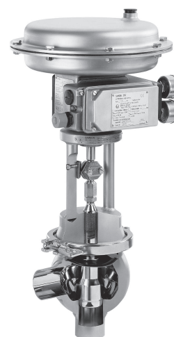
Rys. 1 · Zawór regulacyjny typu 3249-7 w wykonaniu z korpusem kulistym, z pełnego materiału, z końcówkami do spawania, z siłownikiem pneumatycznym typu 3277 i zintegrowanym ustawnikiem pozycyjnym i/p typu 3767
